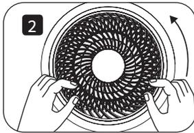
2. Drehen Sie den Schutz des Gebläses im Uhrzeigersinn und entfernen Sie den Schutz.
