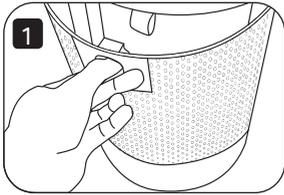
1. Ziehen Sie nach Abschalten des Geräts und Ziehen des Netzsteckers den Griff an der Filterabdeckung hinter dem Produkt nach hinten.
