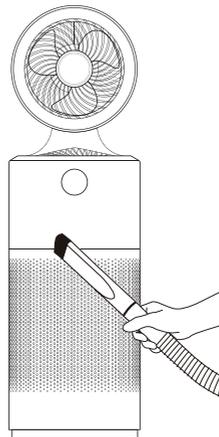
Entfernen Sie Staub an Luftauslass und Lufteinlass mit einem Staubsauger.
