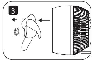
3. Drehen Sie den Schutz des Gebläseflügels und entfernen Sie den Gebläseflügel.
