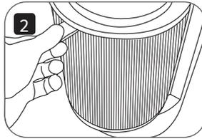
2. Entfernen Sie den Filter und ersetzen Sie ihn durch einen neuen.
